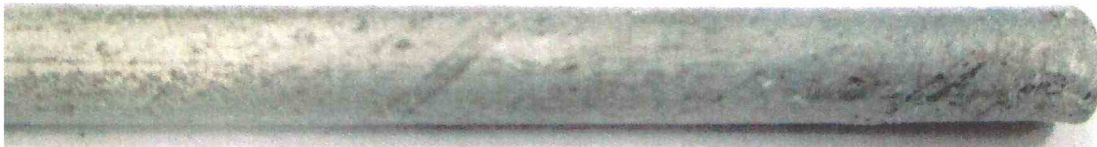
Fot.9: Wygląd próbki O-NaCl-2 po badaniu
