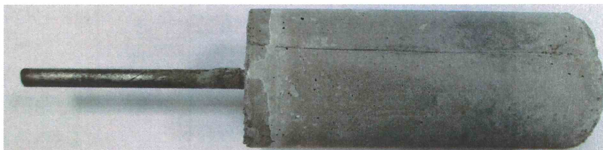
Fot. 1: Przykładowy wygląd próbki do badania podatności korozyjnej
