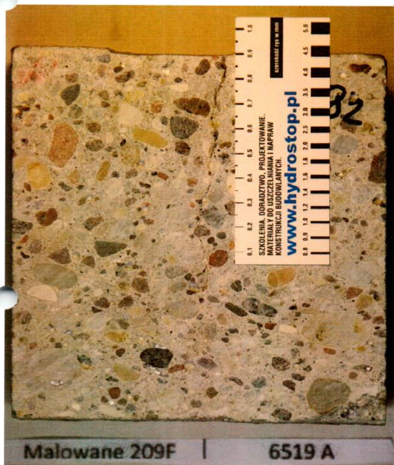
Fig. 1. Beton z powłoką 209F, technika malowania 2x0,8 kg/m 2
