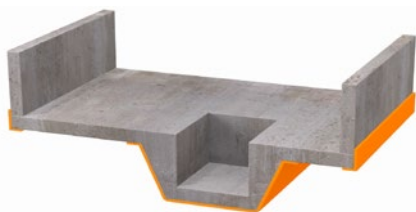
Rys 1. Bok płyty fundamentowej i przegłębienie szybu windowego izolowane produktem Hydrostop-Mata Penetrująca.
